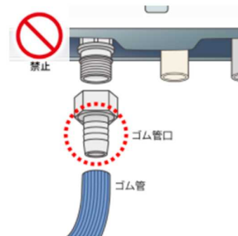
給湯器の接続部※
